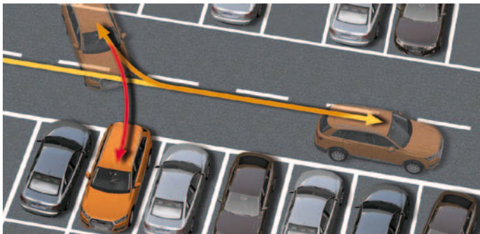
Operación de aparcamiento en batería después de pasar ante el hueco
