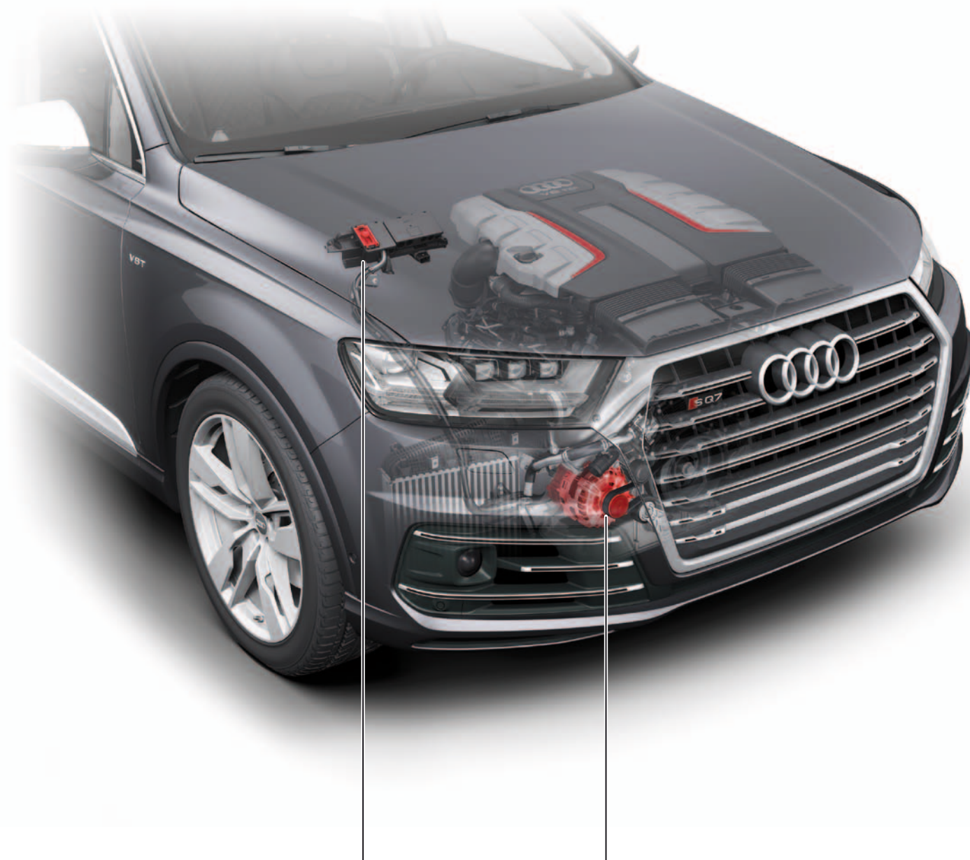
Distribuidor de cables de 12 voltios
