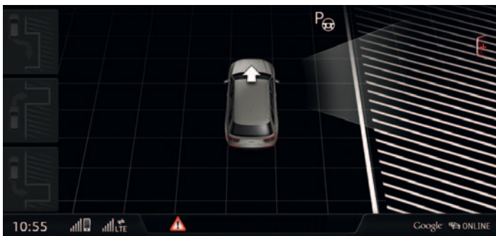
Indicación del asistente de aparcamiento al efectuar un recorrido de búsqueda de puestos de aparcamiento adecuados
