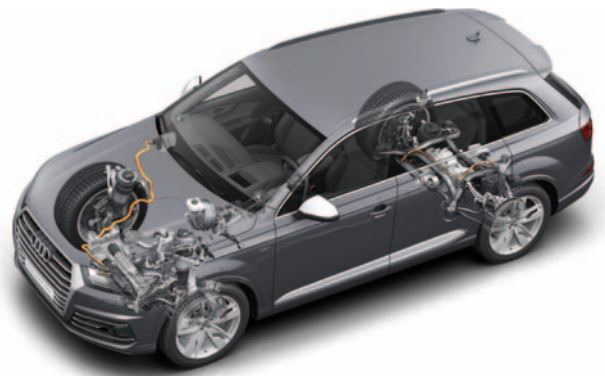
Actuador para "pretensar" mutuamente los lados de la barra estabilizadora; cuanto mayor es el pretensado, tanto mayor es también la rigidez a la torsión
