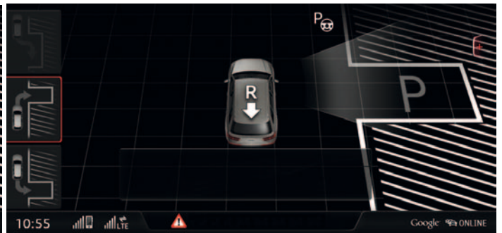
Indicación del asistente de aparcamiento al haber identificado un puesto de aparcamiento en batería
