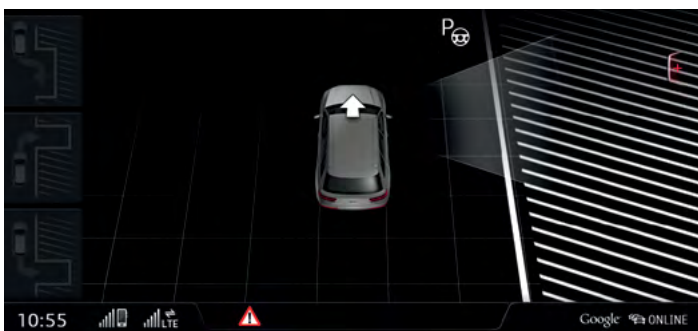
Индикация парковочного автопилота при поиске подходящего парковочного места во время движения
