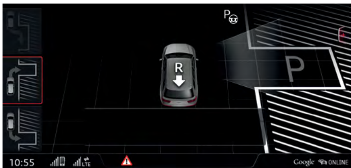
Индикация парковочного автопилота при распознавании поперечного парковочного места
