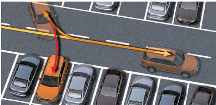
Заезд на поперечное парковочное место после предварительного проезда мимо него
