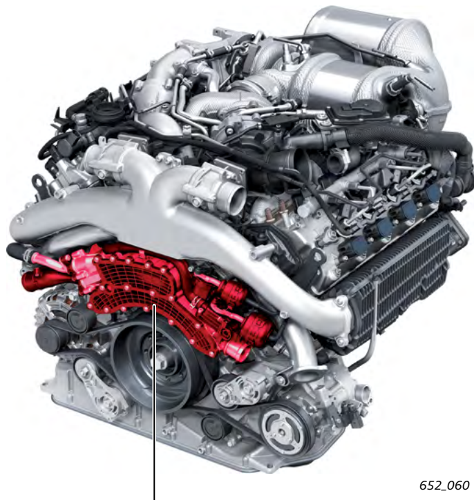
Модуль системы охлаждения с насосом ОЖ
