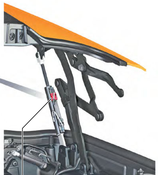
Выключатель закрывания крышки короба складной крыши F519
