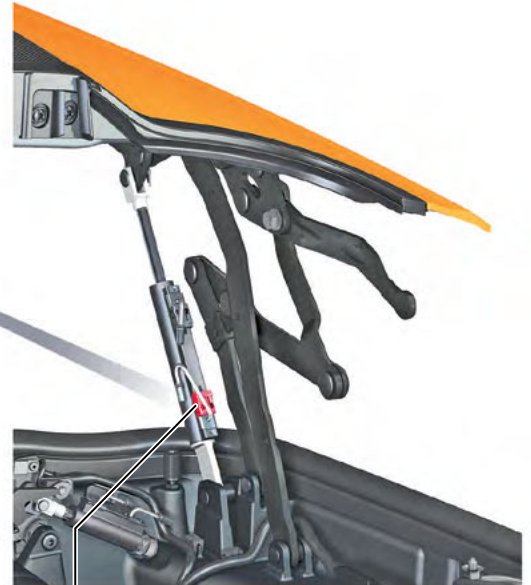
Выключатель короба складной крыши, откр. F407
