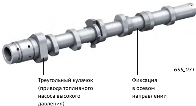
Распредвал выпускных клапанов ряда цилиндров 1
