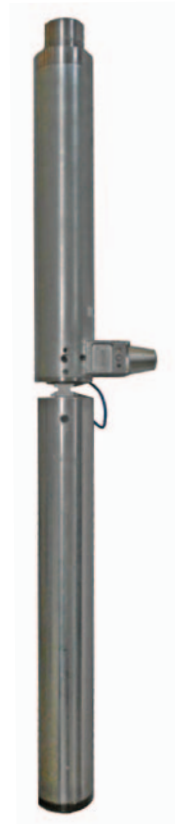
Elemento de ensayo para impactos en las piernas WG 17, utilizado hasta ahora
