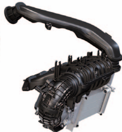
Ladeluftkühler außerhalb des Saugrohres
