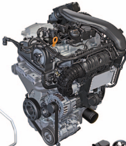
Abgasturbolader mit elektrischem Wastegatesteller
