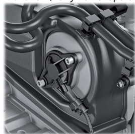
Регулирование фаз распредвала впускных клапанов (70° угла поворота коленвала)
