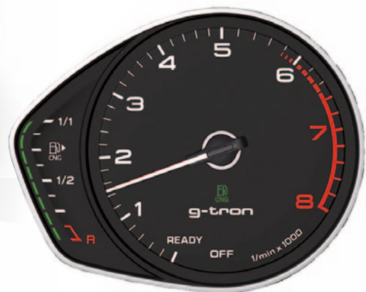
Kraftstoffvorratsanzeige für Erdgas, g-tron Schriftzug im Schalttafeleinsatz und Kontrollleuchte für Erdgasbetrieb im Schalttafeleinsatz
