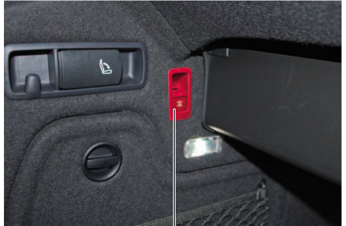
Pulsador para accionamiento de la bandeja del compartimento de la capota E896
