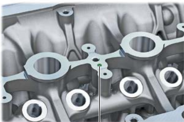
Маслосточный канал от маслоотделителя тонкой очистки
