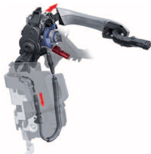
Türaußenbetätigung per Bowdenzug
