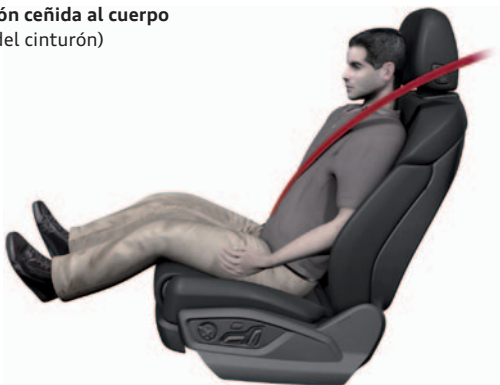
La banda del cinturón va aplicada sobre ropa "gruesa" (mayores holguras del cinturón)
