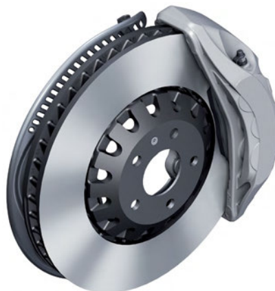
Колёсный тормозной механизм передней оси
