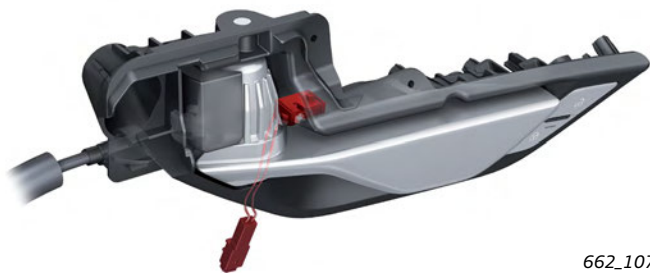
Проём внутренней ручки двери в нерабочем положении
