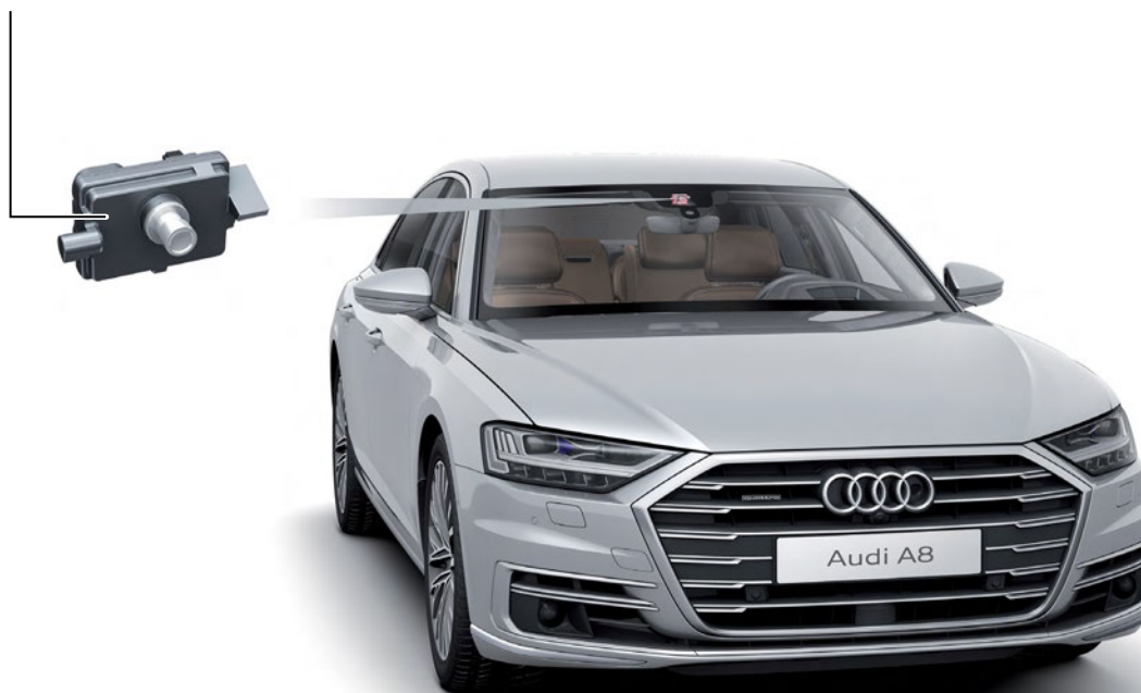
Передняя камера вспомогательных систем водителя R242
