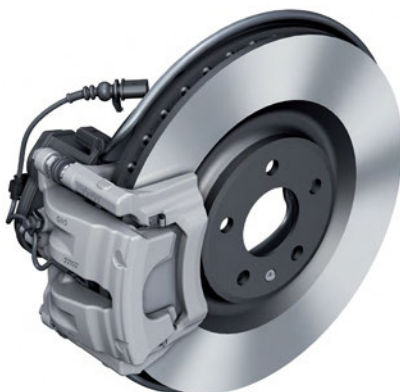
Колёсный тормоз задней оси с EPB
