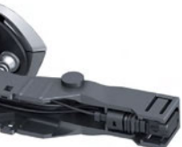
Проём внутренней ручки двери в нерабочем положении
