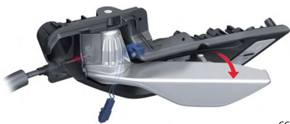
Использование проёма внутренней ручки двери при открывании с помощью троса
