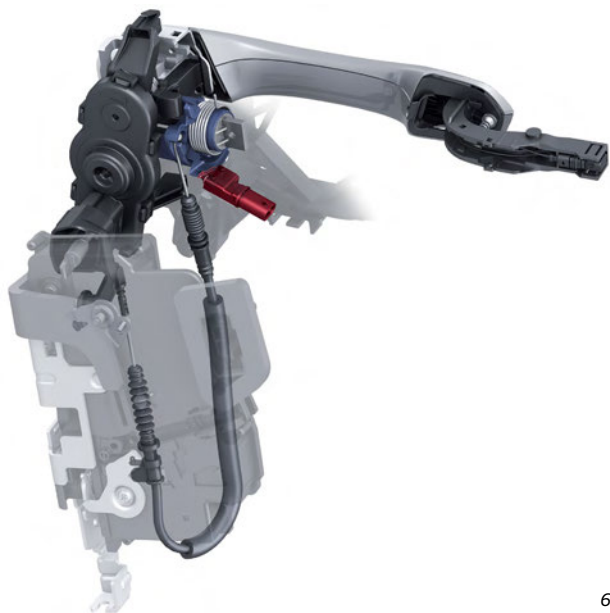
Ручка двери, корпус наружной ручки двери и замок двери в нерабочем положении
