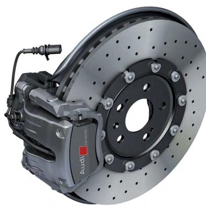
Керамический тормозной механизм заднего колеса
