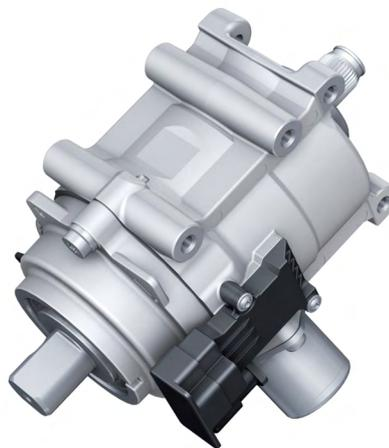
Исполнительный механизм динамического рулевого управления
