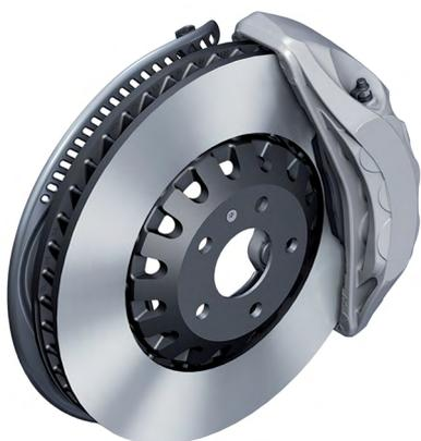
Стандартный тормозной механизм переднего колеса
