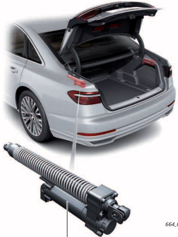
Spindelantrieb = Motor 1 für Heckklappe V444
