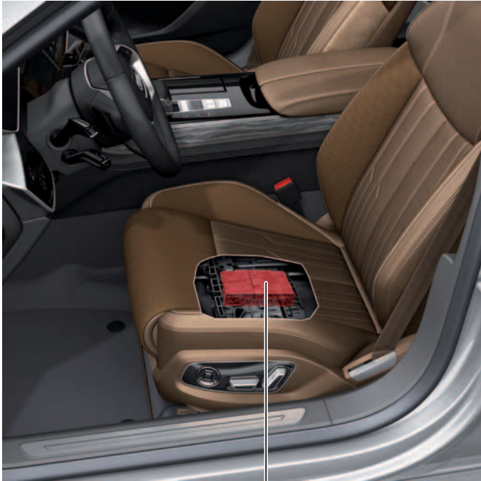
Steuergerät für Sitzverstellung und Lenksäulenverstellung mit Memoryfunktion J136
