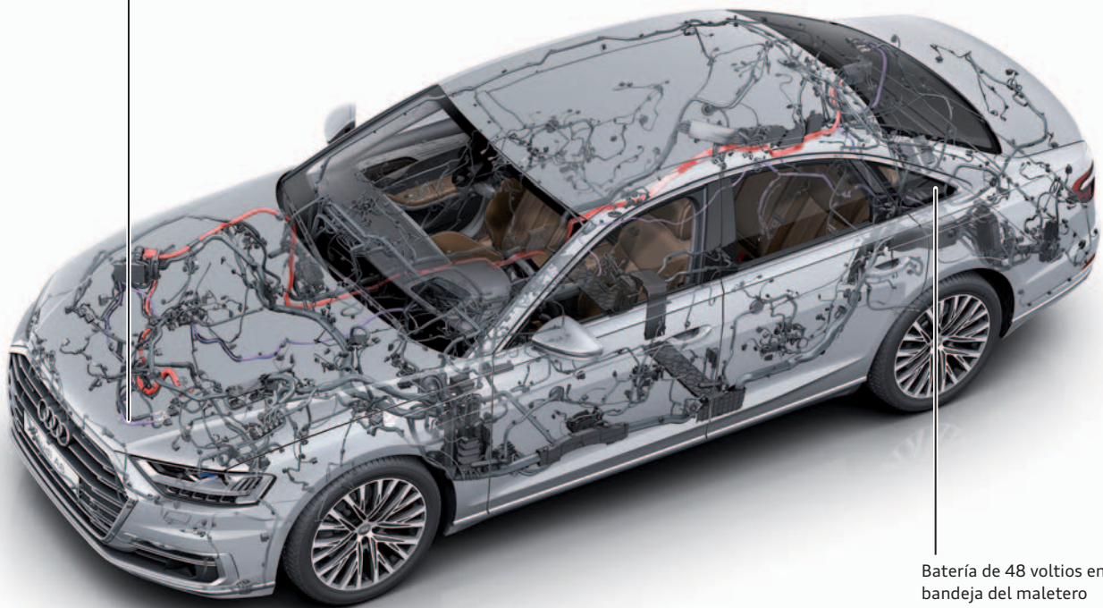
Cables de 48 voltios con aislamiento en color violeta
