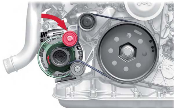
C29 работает в качестве стартера
