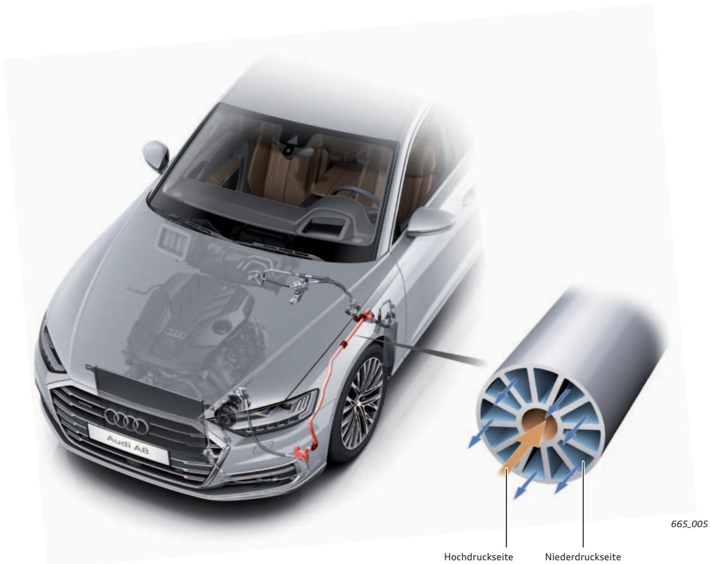
Der interne Wärmetauscher ist von Vorgängermodellen bekannt, wurde allerdings für den A8 (Typ 4N) angepasst.
