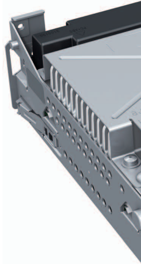
Terminales en la unidad de control del sistema electrónico de información 1 J794
