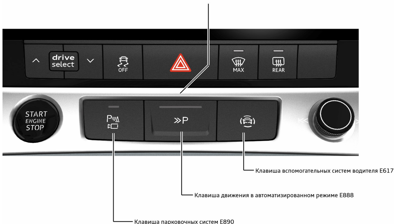
Панель управления 2 ездовыми функциями и функциями комфорта E794
