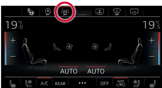
Positionierung des virtuellen Tasters zum Aktivieren bzw. Deaktivieren der Spurverlassenswarnung 668\_004
