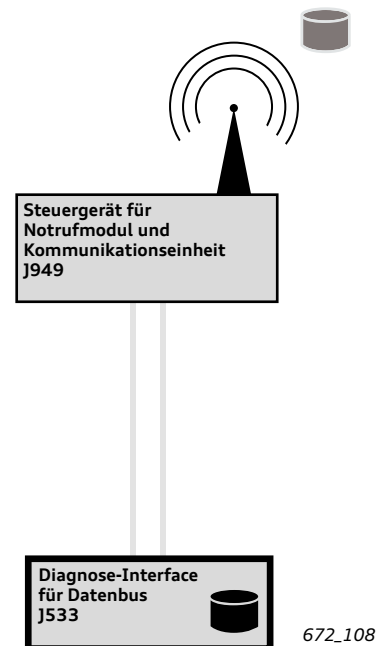
Download und Zwischenspeicherung der Updatedateien für das connected Gateway in den Fahrzeugen mit J949
