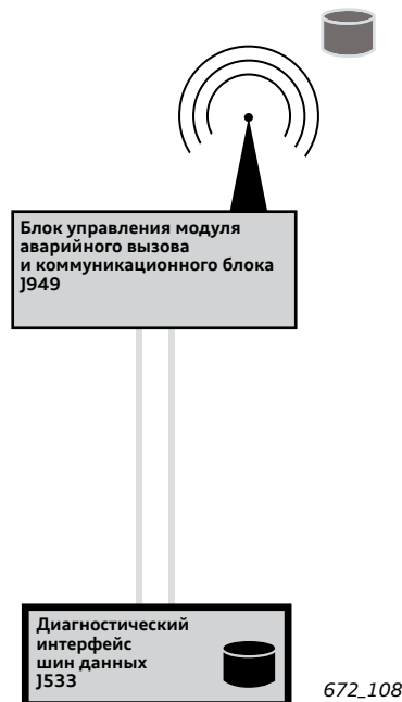
Загрузка и промежуточное сохранение файлов обновления для connected Gateway в автомобилях с J949
