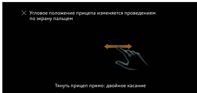
Поле ввода при активном ассистенте маневрирования с прицепом на нижнем сенсорном дисплее 672_089
