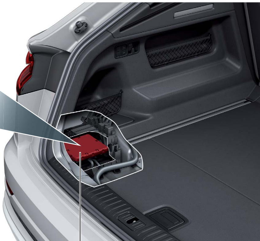
Центральный блок управления систем комфорта J393 установлен так, что электрические разъёмы обращены вниз
