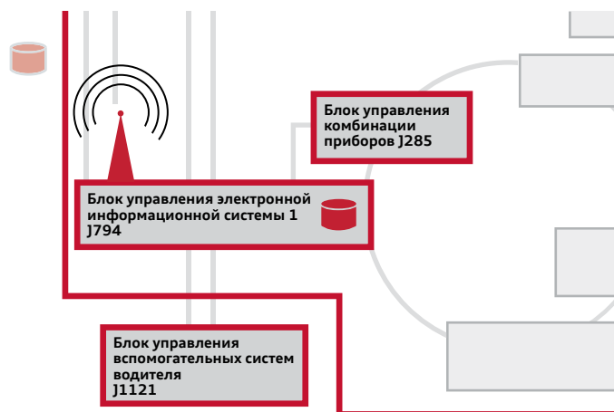
Загрузка и промежуточное сохранение файлов обновления для блоков управления Infotainment, Audi virtual cockpit и блока управления вспомогательных систем водителя
