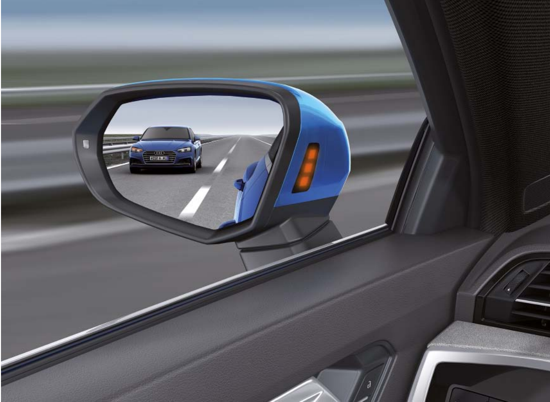
Aktive Warnleuchte der Spurwechselwarnung im linken Außenspiegel
