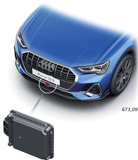
Правый датчик адаптивного круиз-контроля G259 и блок управления адаптивного круиз-контроля J428
