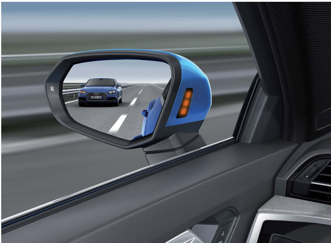
Включённая сигнальная лампа системы предупреждения о смене полосы движения в левом наружном зеркале
