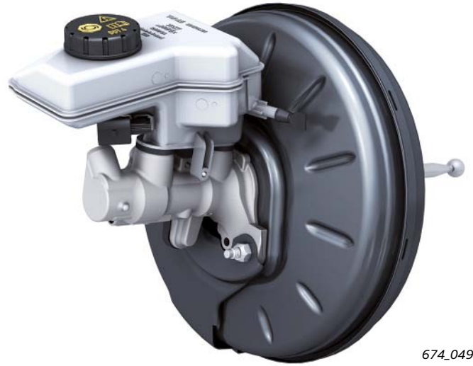
Single-Bremskraftverstärker für Linkslenkerfahrzeuge
