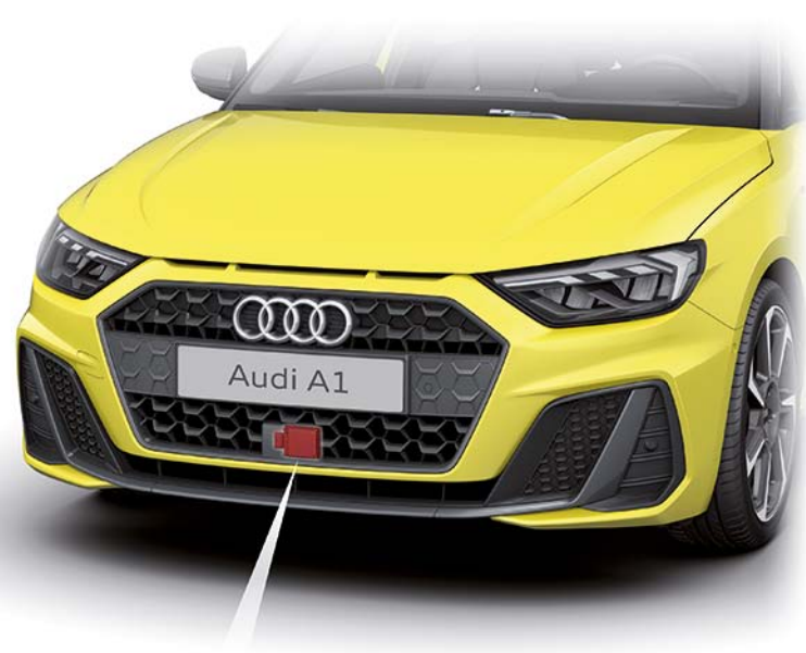
Geber für ADR rechts G259 und Steuergerät für Abstandsregelung J428
