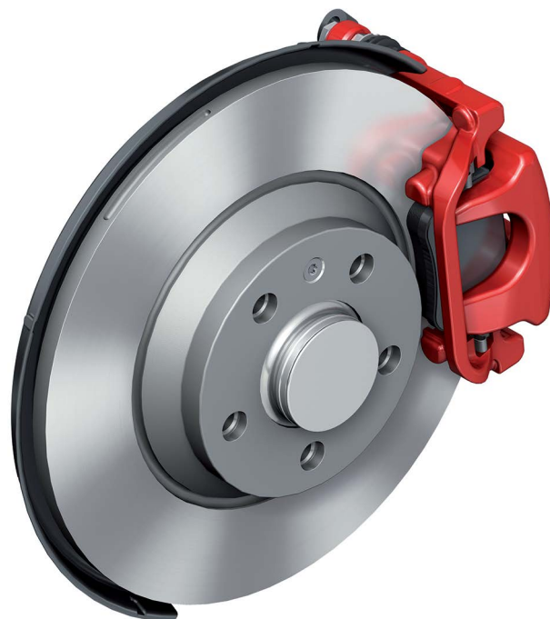
15" – ZF с плавающим суппортом 674_048
