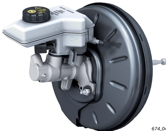
Одинарный усилитель тормозов в автомобилях с левосторонним расположением рулевого управления
