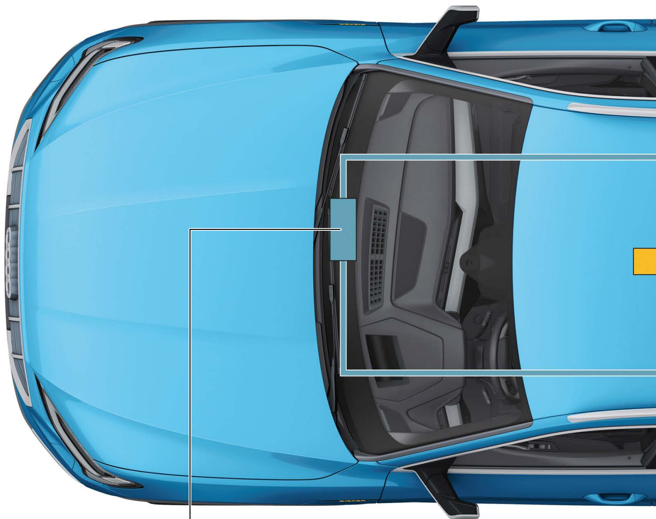
Блок управления электронной информационной системы 1 J794
