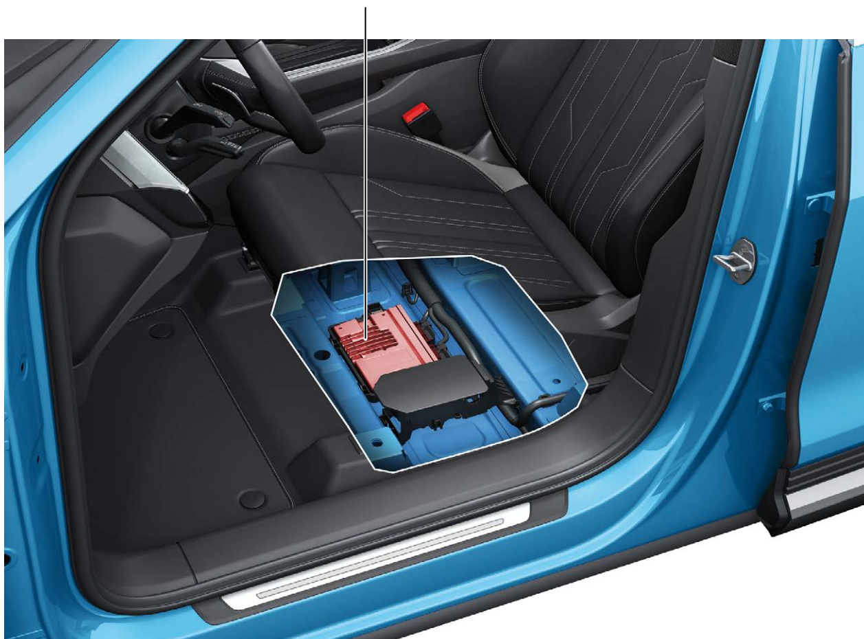
Диагностический интерфейс шин данных J533
