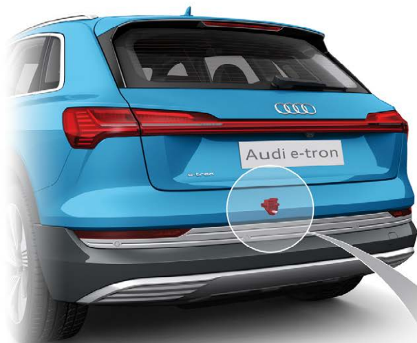
Датчик удара сзади G572
