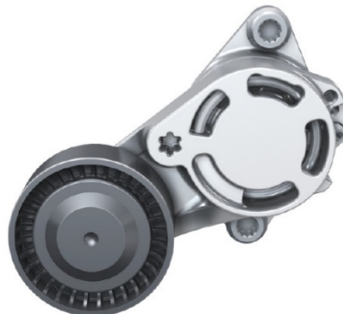
Натяжитель поликлинового ремня компрессора климатической установки (натяжитель с демпфером)
