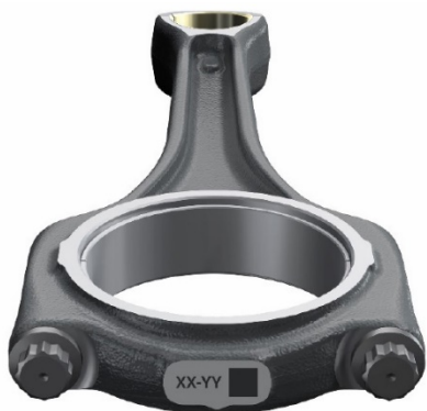
Вид двухмерного матричного штрихкода XX — весовая группа нижней головки шатуна YY — весовая группа верхней головки шатуна
