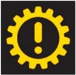
Im Kombiinstrument erscheint die gelbe Getriebekontrollleuchte mit dem Hinweis: Getriebe: Wegrollgefahr! P nicht möglich. Bitte Parkbremse betätigen.
