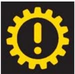
Erscheint im Kombiinstrument die gelbe Getriebe-Kontrollleuchte, kann das Fahrzeug in der Regel weiterbewegt werden. Ein entsprechender Fahrerhinweis informiert den Fahrer was zu tun ist.
