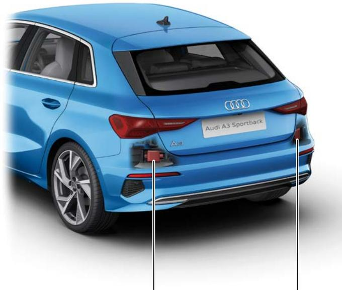
Steuergerät 2 für Totwinkelerkennung
