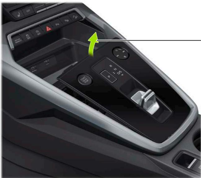
Einsatz mit Schaltbetätigung aushebeln
