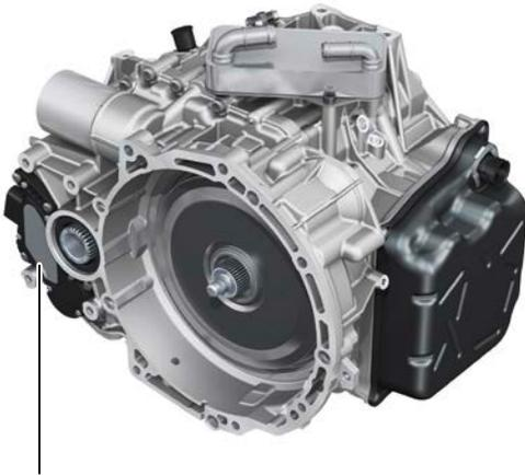
Zusatzhydraulikpumpe 1 für Getriebeöl V475
