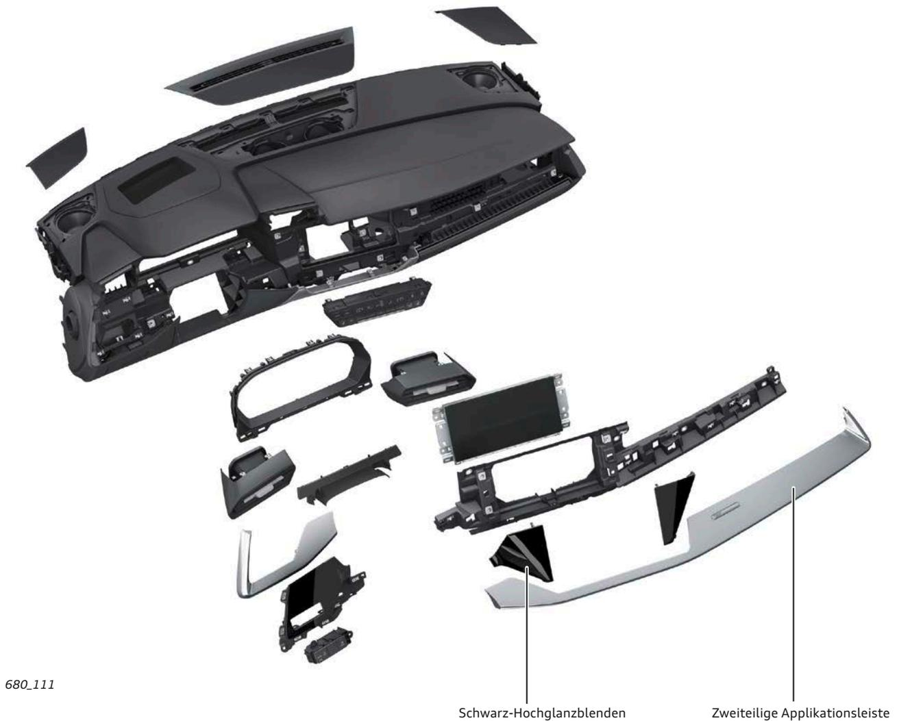
Das Cockpit im Audi A3 (Typ 8Y) ist sehr fahrerorientiert. Dazu trägt einerseits das stark zum Fahrer geneigte MMI-Touch-Display bei. Andererseits sorgt die Position der fahrerseitigen Schalttafel ausströmer direkt rechts und links vom Schalttafel einsatz und weit oben angebracht zusätzlich für eine optische Betonung der Fahrerseite. Dieser Effekt verstärkt sich noch durch die auf der Beifahrerseite tiefer in der Schalttafel integrierten Luftaustrittsdüsen.
