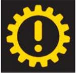
Aus diesem Grund erscheint im Kombiinstrument die gelbe Getriebekontrollleuchte mit dem Hinweis: Getriebe: Störung! Weiterfahrt möglich. Siehe Bordbuch.
