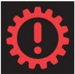
Erscheint im Kombiinstrument die rote Getriebe-Kontrollleuchte, wird der Fahrer angewiesen nicht weiterzufahren.
