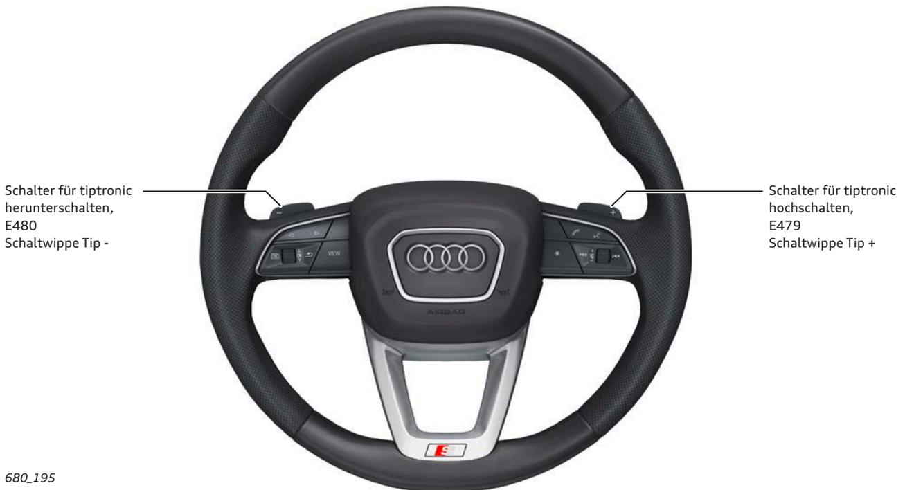
Im tiptronic-Betrieb, auch manueller Modus M genannt, können die Gänge manuell über die Schaltwippen geschaltet werden. In der Wählbereichsanzeige Y5 leuchtet das Symbol D/S und im Kombiinstrument erscheint die Ganganzeige: „M“ 1 – 7.
