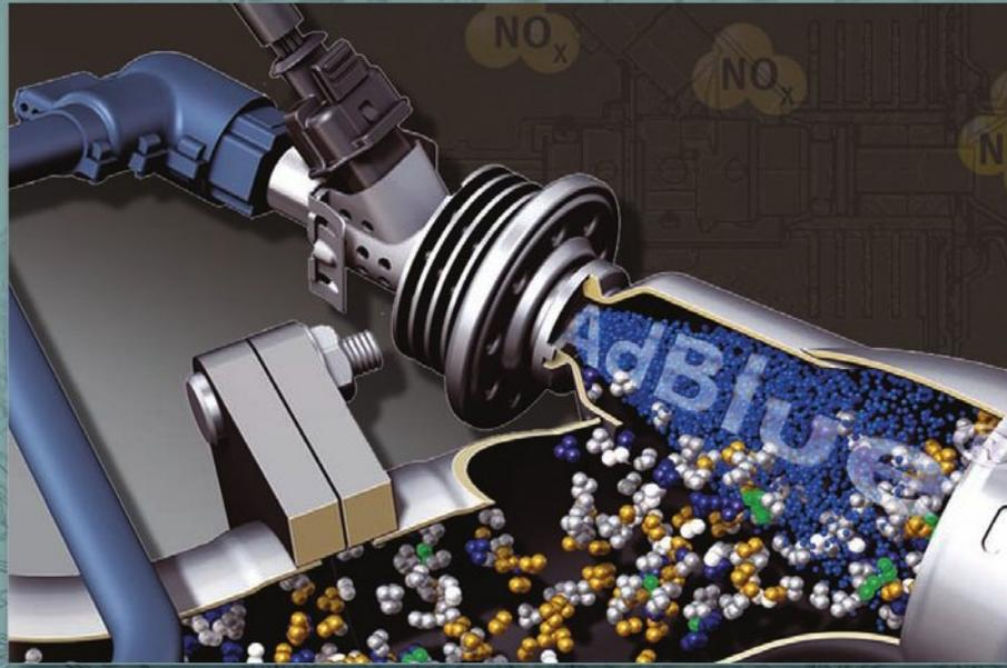
Система Избирательного Каталитического Восстановления оксида азота (NO<sub>x</sub>), более известная, как система SCR (уменьшение уровня оксида азота за счёт введения добавок в поток выхлопных газов).
