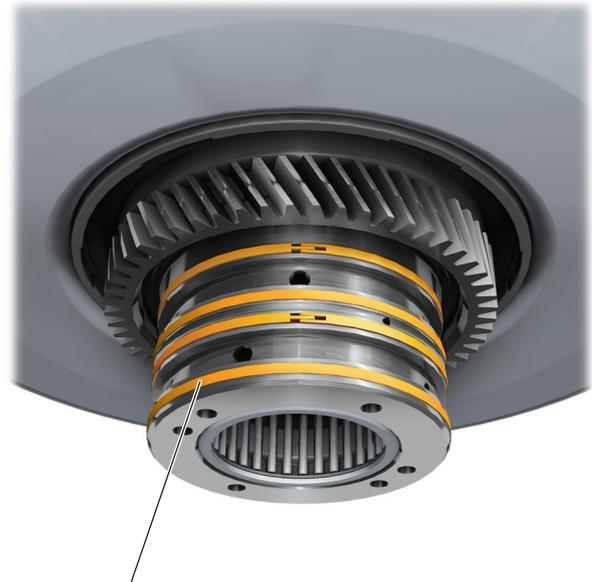
Um 180° versetzte Dichtungen der Druckübergabe zur Doppelkupplung
