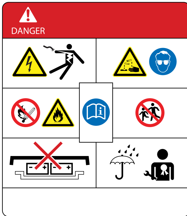
Warnung auf der Hochvoltbatterie
