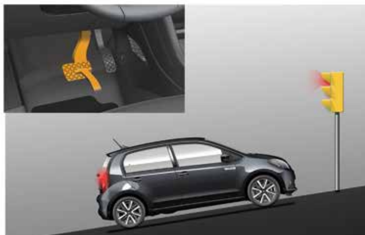
Berganfahrassistent „Hill Hold Control“
