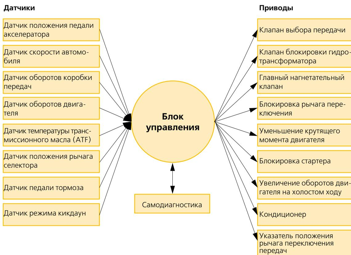
Момент переключения передачи рассчитывается цифровым микропроцессором блока управления.
