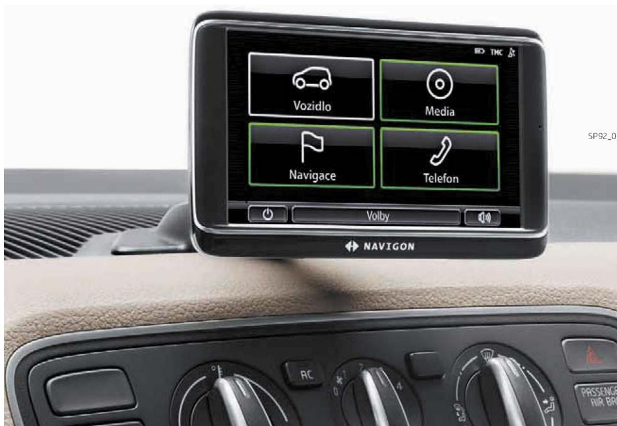
Некоторыми важными функциями можно управлять без сенсорного экрана, а именно: с клавиш головного устройства Funky в центральной консоли. Например, при воспроизведении на дисплее навигатора Move&Fun карты, так можно управлять функциями музыкального плеера (переключаясь между выбором файлов и регулированием громкости).
