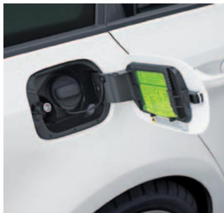
Die Lage des Befüllstutzens für Erdgas am Fahrzeug Octavia G-TEC.
