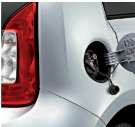
Die Lage des Befüllstutzens für Erdgas am Fahrzeug ŠKODA Citigo.
