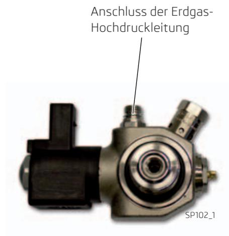
Das Absperrventil mit einem Anschluss der Erdgas-Hochdruckleitung zur parallelen Verbindung der Kraftstofftanks mittels des Anschlusses an das Verteilungsstück beim Fahrzeug ŠKODA Octavia III.
