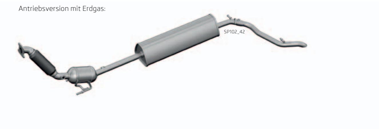
Die Abgasrohrleitung beim Modell ŠKODA Citigo CNG mit Erdgasantrieb ist verkürzt und auf der linken Seite unter dem unteren Karosseriebereich beendet, im Bereich vor der Hinterachse (aus Gründen der Platzierung des CNG-Kraftstofftanks im Bereich vor und hinter der Hinterachse).
