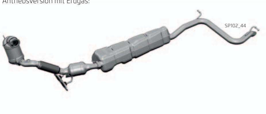
Die Abgasrohrleitungen beim Modell ŠKODA Octavia G-TEC mit Erdgasantrieb ist verkürzt und auf der linken Seite unter dem unteren Karosseriebereich beendet, im Bereich vor der Hinterachse (dieses aufgrund der Platzierung des Kraftstofftanks für CNG im Bereich hinter der Hinterachse). Aus diesem Grund musste auch der hintere Auspuffschalldämpfer entfernt werden. Bei der Fahrzeugversion mit Erdgasantrieb wird ein spezieller erweiterter vorderer Schalldämpfer verwendet.
