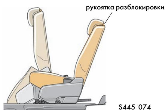
С помощью рукоятки разблокировки, находящейся вверху сбоку на спинке сиденья, клиент может отвести спинку сиденья вперед (в т. н. положение «Easy Package») и, дополнительно, сдвинуть всё сиденье целиком вперед до упора. Это положение обеспечивает удобный доступ к сиденьям третьего ряда для посадки или высадки.
