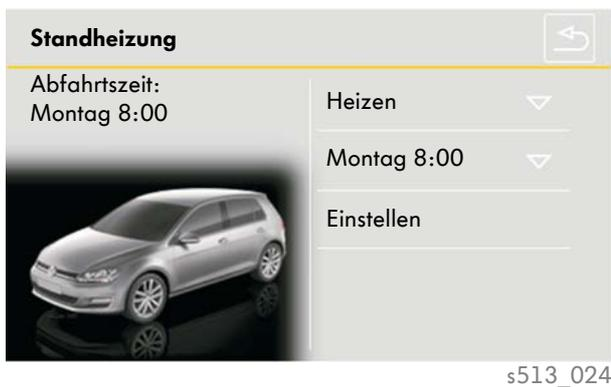
Menü „Standheizung“ bei Verbau einer Climatronic
