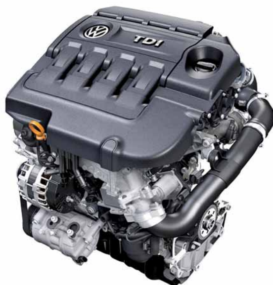
Kraftstoffsystem mit einem Einspritzdruck von max. 2000 bar
