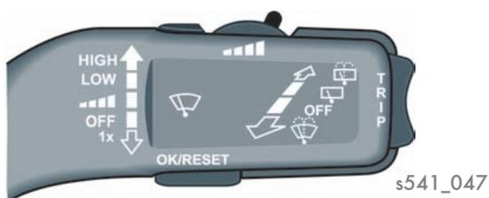
Управление с помощью подрулевого переключателя
