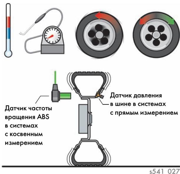
Эти параметры могут измеряться прямым способом с помощью датчиков давления, температуры и ускорения, если эти датчики установлены прямо на колесе.
