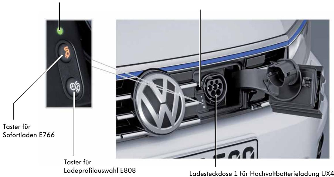
Der Ladevorgang beginnt automatisch, sobald das Fahrzeug ordnungsgemäß mittels Ladekabel an das Stromnetz angeschlossen wurde. Alternativ kann das System so programmiert werden, dass der Ladevorgang zu einem definierten Zeitpunkt abgeschlossen ist.
