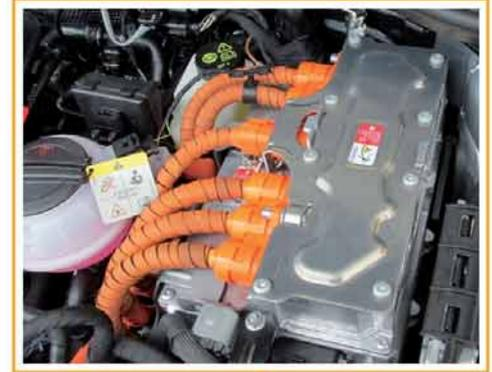
Elektromodulbox mit Relais- und Sicherungshalter SB und Multifuse-Vorsicherungshalter SA
