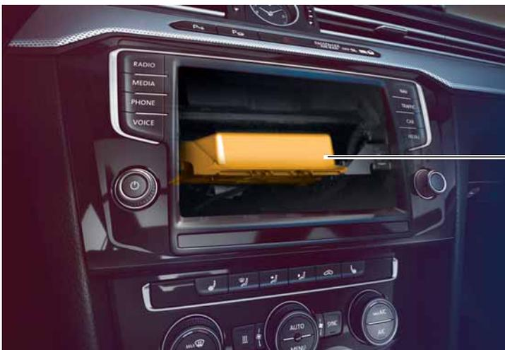
Steuergerät für Notrufmodul und Kommunikationseinheit J949
