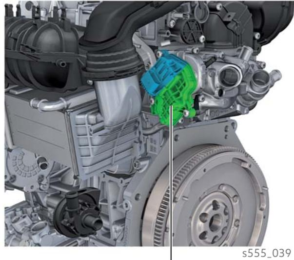
Modul für Motortemperaturregelung GX33
