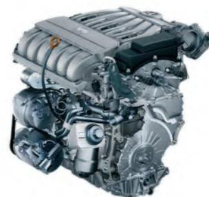
В 2011 году на Touareg Hybrid впервые был применён двигатель с классической компоновкой V6. У него был стандартный угол развала цилиндров 90°. С рабочим объёмом 3,0 л и приводным нагнетателем между головками блока цилиндров этот двигатель развивал мощность 240 кВт. В режиме kick-down мощность привода ДВС и тягового электродвигателя складывалась в максимальную суммарную мощность 279 кВт.
