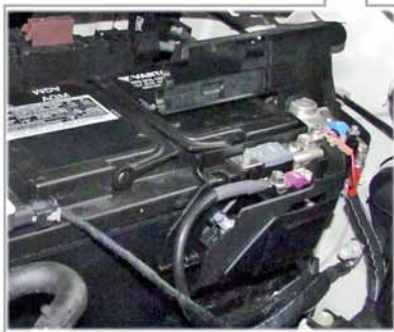
Sicherungshalter F (SF) an der Zweitbatterie
