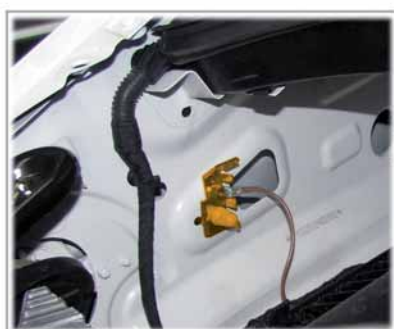
Im Motorraum rechts Masseanschluss für Fremdstart
