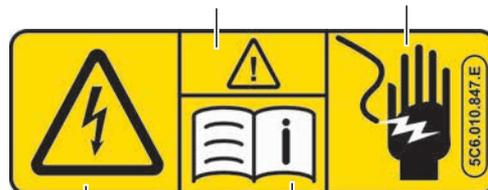
Предупреждение об опасном электрическом напряжении в соответствии с DIN 4844-2 (BGV A8)
