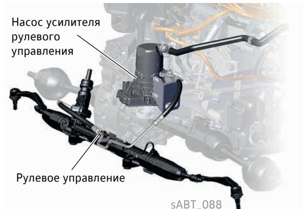
Насос усилителя рулевого управления установлен на резино-металлических опорах в задней части тягового двигателя электропривода, над рулевым механизмом.
