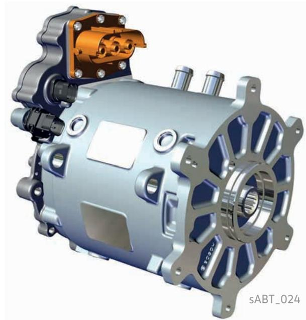
Температура электропривода контролируется датчиком температуры тягового электродвигателя G712, установленным в статоре. Сигнал датчика температуры тягового электродвигателя используется для регулирования охлаждения электропривода. При слишком высокой температуре мощность тягового электродвигателя понижается.
