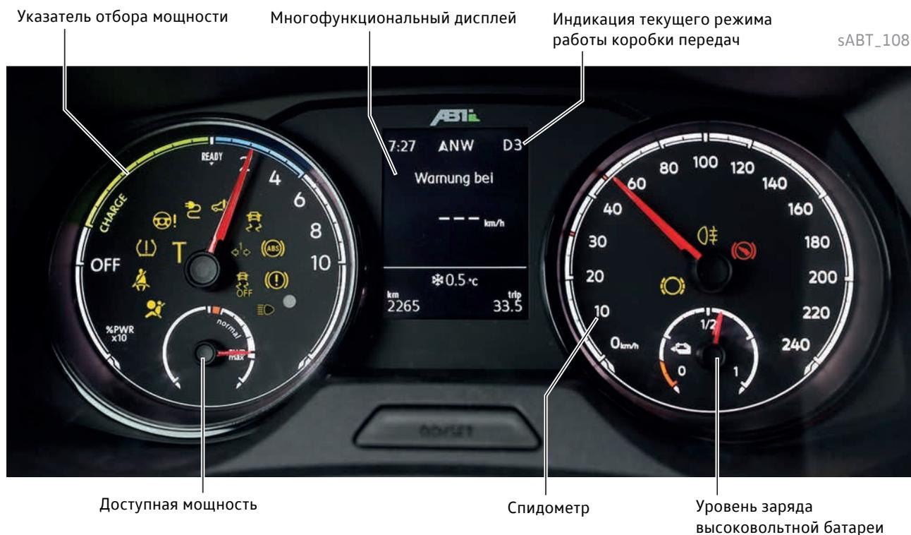
В комбинации приборов ABT e-T 6.1 предусмотрены перечисленные ниже индикаторы, добавленные специально для электромобилей, и модифицированная концепция сигнальных ламп. В зависимости от модели доступны два варианта исполнения комбинации приборов с различными спидометрами: до 160 и 240 км/ч. Расположение и назначение индикаторов в обеих комбинациях приборов одинаково.
