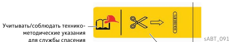
В экстренном случае следует перерезать отмеченный провод, имеющий маркировку для спасательных служб. При перерезании провода разрывается цепь питания блока управления системы регулирования АКБ J840 в высоковольтной батарее 1 AX2.
