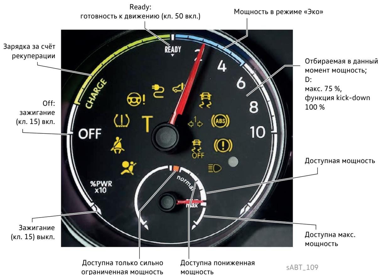
В левой части комбинации приборов для водителя отображается различная информация о текущем рабочем состоянии автомобиля, например:
