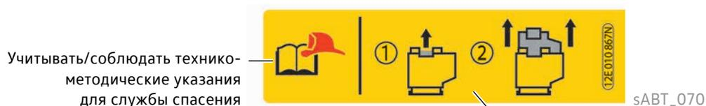
Сжать фиксатор разъёма и разъём в верхней части и вытянуть вверх. В результате размыкания сервисного разъёма высоковольтной системы TW разрывается контрольная цепь и цепь питания блока управления системы регулирования АКБ J840 в высоковольтной батарее 1 AX2.
