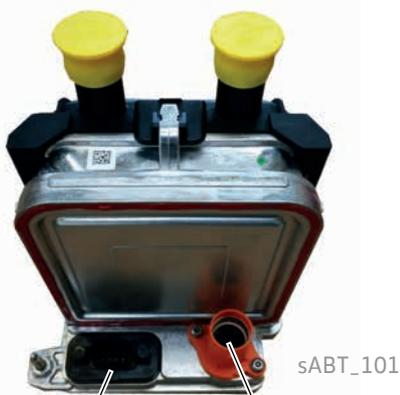
Низковольтный разъём, шина данных LIN, контрольная цепь
